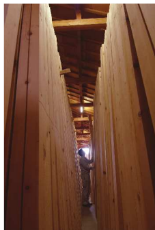
写真上：当社天然乾燥場 常温で最低3年以上自然乾燥させることで、シロアリの嫌いな芳香成分を残している。
